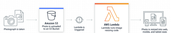
Figure 1. Exemplo de função serverless de redimensionamento de imagens, na plataforma AWS Lambda .
