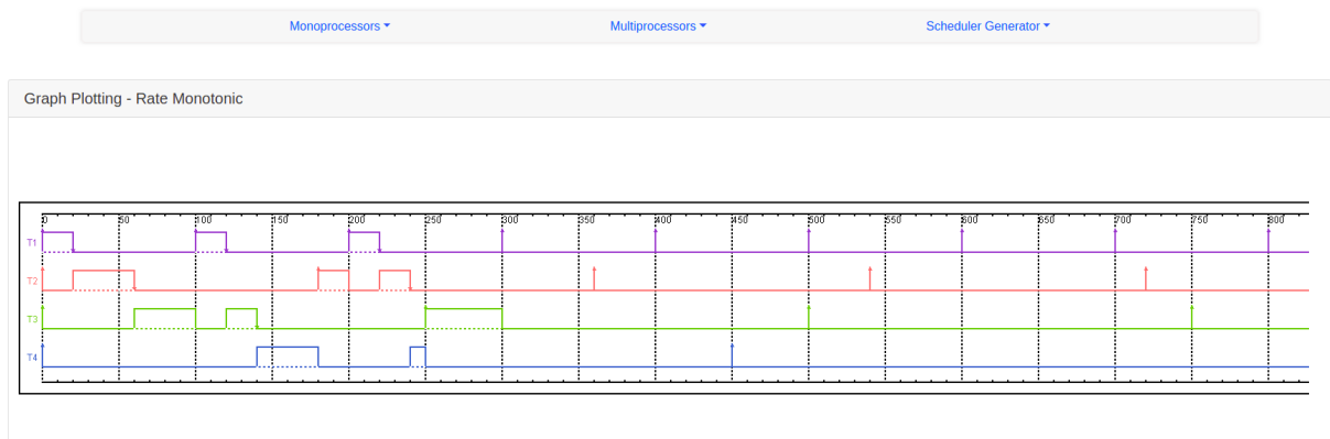
Figura 4.10 – Gráfico do escalonamento obtido pelo algoritmo Taxa Monotônica no Web-RTsim
