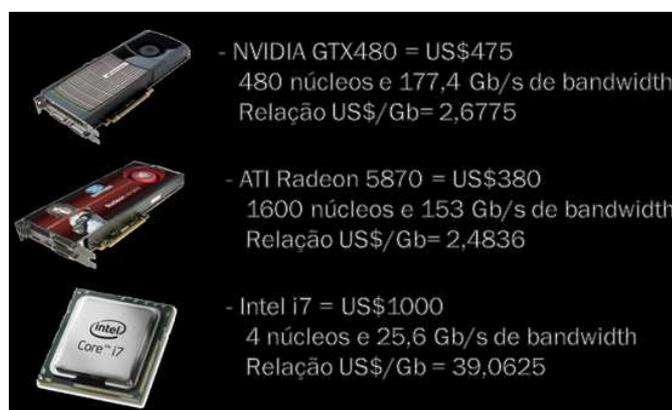
Fig. 1.3: Comparação entre preços e *bandwidth* de GPU's e CPU.
